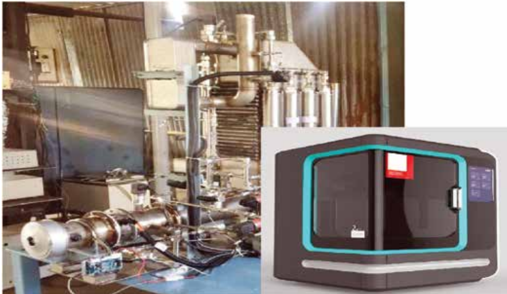
चित्र 1. मिथेनॉल ईंधन प्रोसेसर और मिथेनॉल संचालित उच्च ताप पॉलीमर इलेक्ट्रोलाइट मेम्ब्रेन ईंधन सेल प्रणाली प्रोटोटाइप
