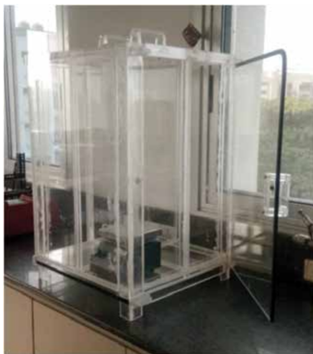
चित्र अनुकूलित निर्मित फोटो रिएक्टर और बहुउद्देश्यीय निष्क्रियता के लिए इसका डिजाइन
