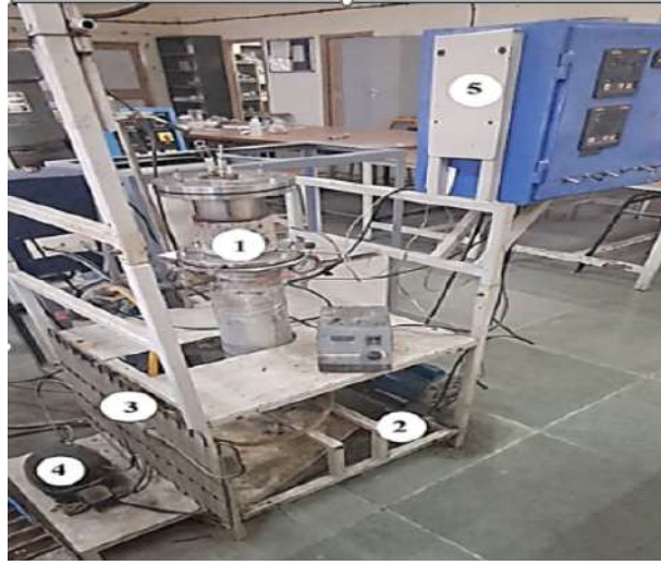
चित्र: परवेपोरेशन की स्थापना; 1-5 (फीड टैंक, वैक्यूम पंप, चिलिंग कॉइल, कंप्रेसर, प्रोसेस वेरिएबल कंट्रोलर)
