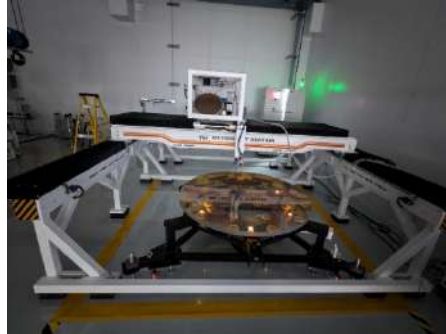
चित्र: मध्यवर्ती स्थानिक आवृत्ति मापन हेतु सब अपचर स्टेशन विषयक पॉलिश राउंडल इंटरफेरोमीटर मेट्रोलॉजी स्टेशन
