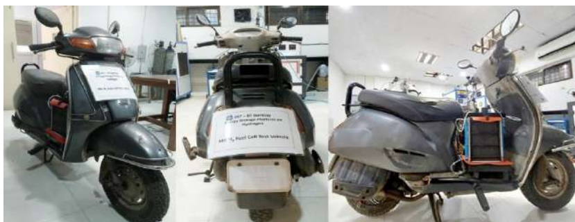
चित्र: स्कूटर पर एकीकृत पीईएमएफसी वाले धातु हाइड्राइड-आधारित हाइड्रोजन भंडारण का संकल्पना साक्ष्य।
