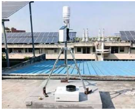
चित्र: आईआईटी दिल्ली के वी ब्लॉक की शीर्ष मंजिल पर कस्टम-डिजाइन किए गए स्वचालित मौसम स्टेशन (एडब्ल्यूएस) की स्थापना, साथ ही एटीएमओएस41 मौसम स्टेशन के साथ आकार की तुलना।
