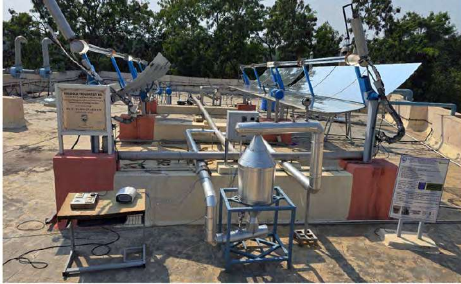
चित्र: एआरसीआई में मौजूदा पीटीसी टेस्ट रिग के साथ एकीकृत 1 किलोवाट घंटा (kWh) टीईएस
