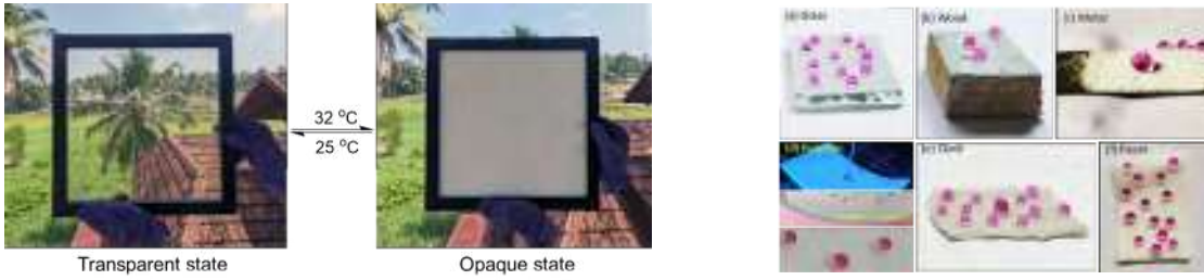
चित्र: (बाएँ) ट्रांसपेरेंसी स्विचिंग एलसीएसटी-आधारित थर्मोक्रोमिक स्मार्ट विनो प्रोटोटाइप; (दाएँ) मल्टी-सबस्ट्रेट संगत हाइब्रिड सुपरहाइड्रोफोबिक कंपोजिट कोटिंग्स।
