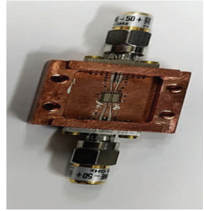
चित्र. प्रोटोटाइप जोसेफसन पैरामीट्रिक एम्पलीफायरों को दिखाने वाली एक तस्वीर।
