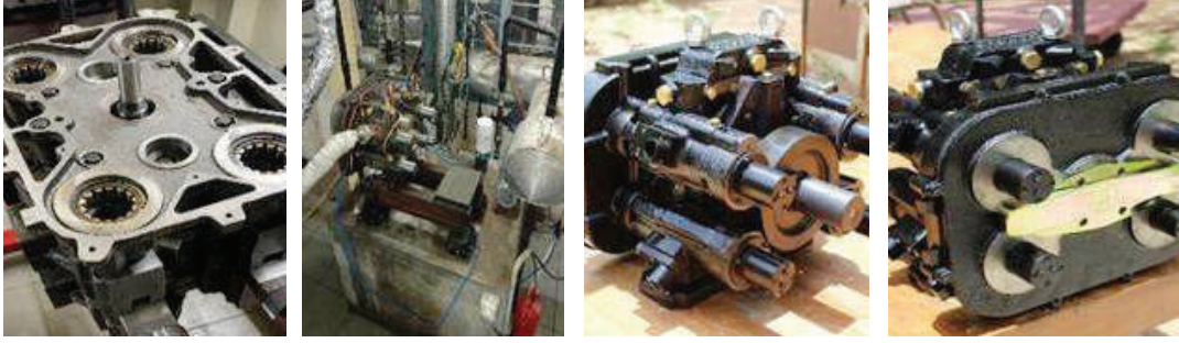
चित्र: निम्न दाब सौर एवं प्रक्रिया भाप के साथ प्रयोग हेतु वॉल्यूमेट्रिक रूप से नियंत्रित वेंकेल स्टीम एक्सपैंडर
